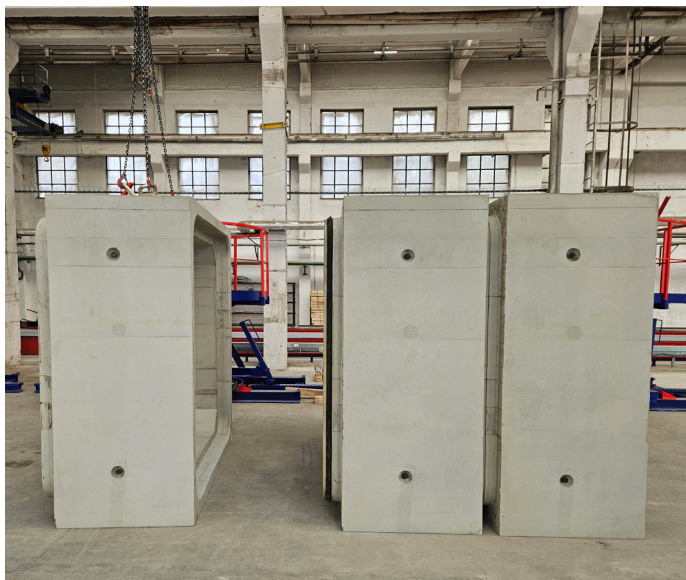
Vnější spára po stažení rámových propustí
