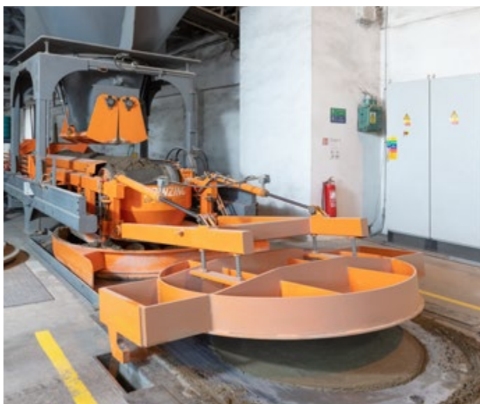
Proces výroby polotovaru systémem vibrolisování
