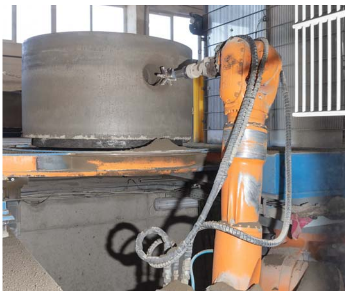
Rychlý nárůst počátečních pevností umožňuje beton frézovat v řádu jednotek hodin po výrobě
