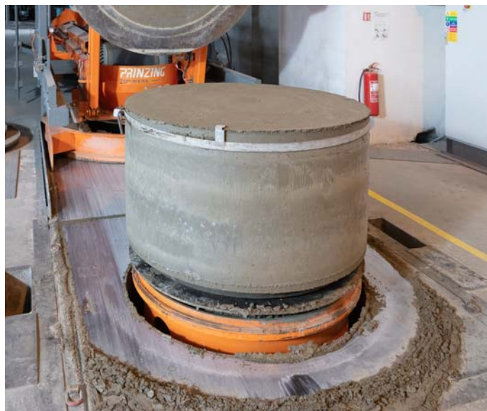
Hotový vibrolisovaný polotovar šachtového dna – výroba v obrácené poloze
