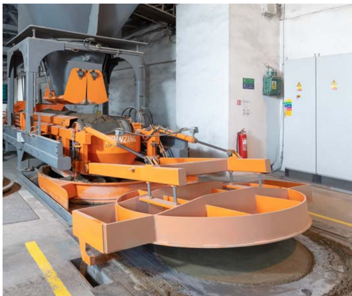
Proces výroby polotovaru systémem vibrolisování
