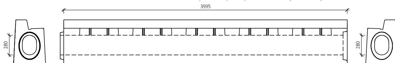
BEST TROUBA S PŘERUŠOVANÝM ŠTĚRBINOVÝM ŽLABEM, ROVNÁ 20/28-28, OBRUBNÍK 12 cm (PROFIL LEVÝ)
