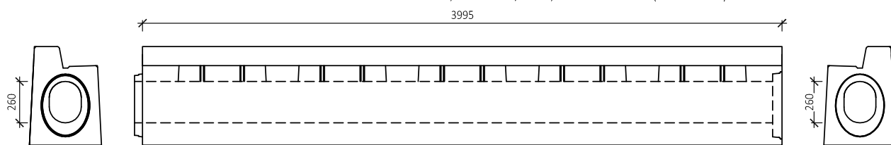
BEST TROUBA S PŘERUŠOVANÝM ŠTĚRBINOVÝM ŽLABEM, ROVNÁ 20/28-28, OBRUBNÍK 12 cm (PROFIL LEVÝ)
